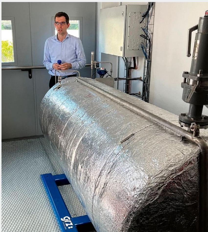
Fig. 2 Système à hydrure métallique pour le stockage du H<sub>2</sub> produit par électrolyse de l'eau.
